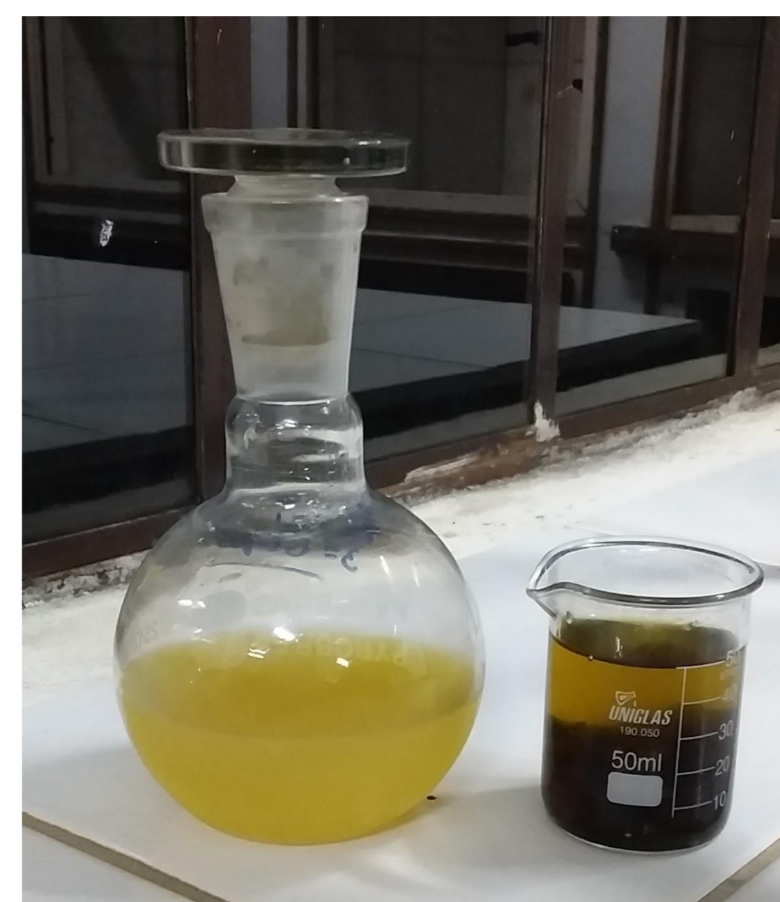
Fig. 3. Limoneno e eugenol extraído do cravo-da-índia por extração com solvente
