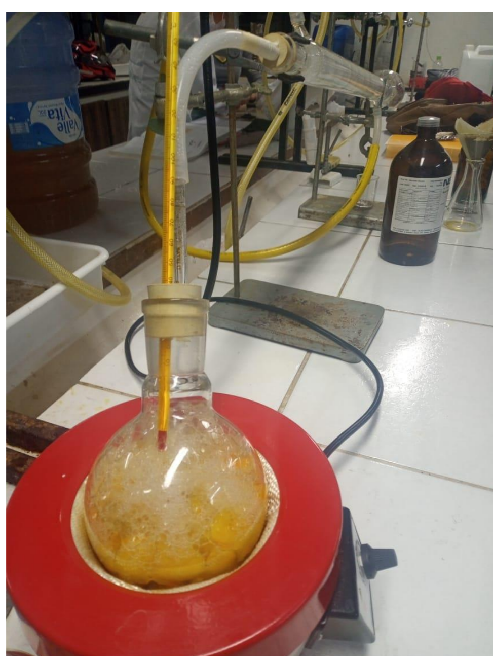
Fig. 1. Extração do limoneno da casca do limão por destilação simples
